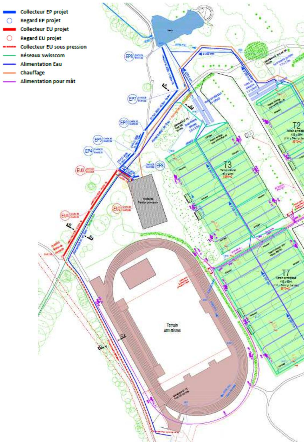
Figure 24 : Extrait du plan des réseaux existants et projetés (source : Perreten & Milleret, mai 2021)
